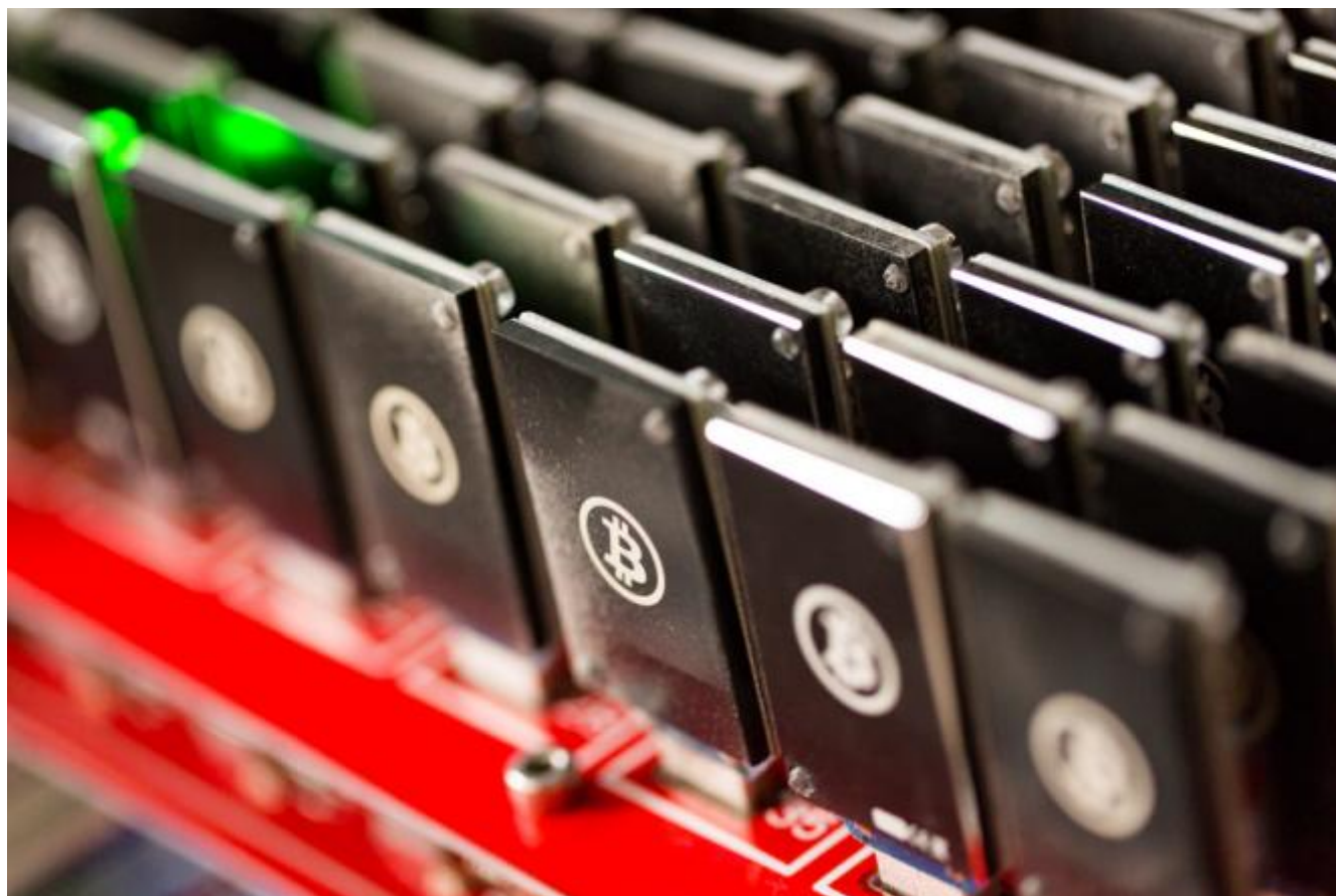
Machine dédiée au minage de bitcoins
